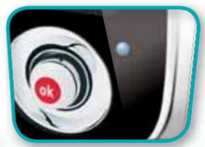
Si la conexión se establece correctamente, el testigo azul se queda fijo.
